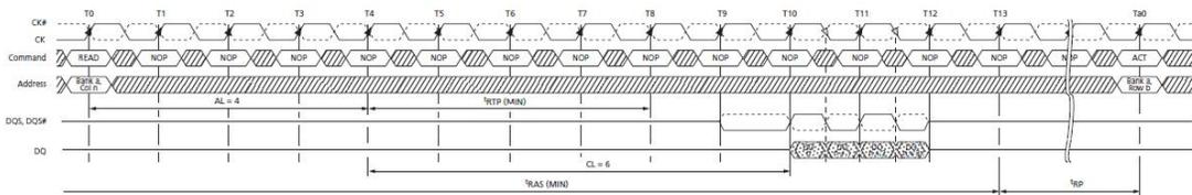
图 13 读取操作-带自动预充电
