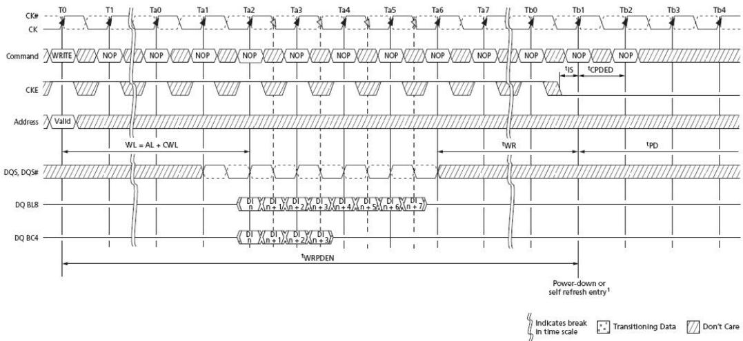
图 33 写命令后进入 Power-Down 时序
