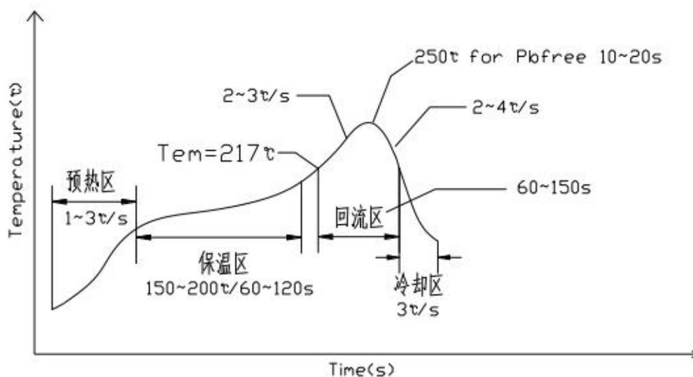
图 5-2 无铅回流焊曲线图
