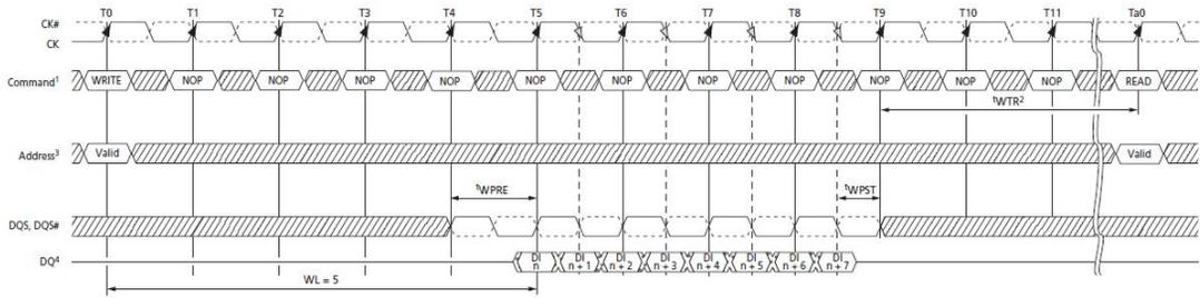
图 28 写入操作到读取操作时序 (BL8)
