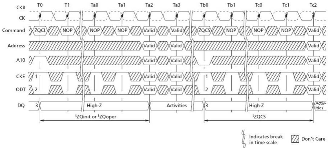
图 30 ZQ 校准时序 ((ZQCL and ZQCS))
