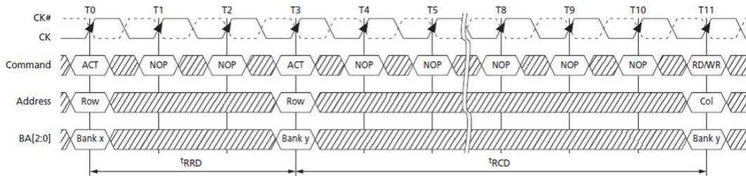
图 10  $t_{RCD}$  和  $t_{RRD}$  时序
